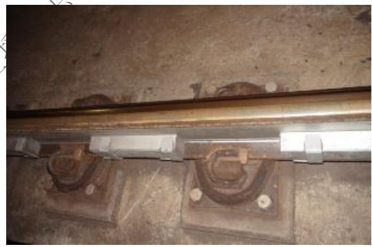
图 3. 宽频型钢轨阻尼减振降噪装置
